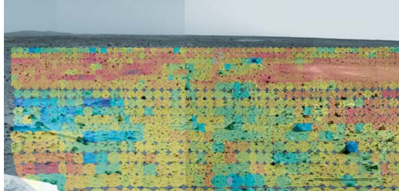
РЕЗУЛЬТАТ ТЕПЛОВОГО СКАНИРОВАНИЯ области от группы Восточных холмов до Сонной долины. Пыль, тепловая инертность которой мала, теплее (красный цвет): она быстро нагревается солнцем. Камни обладают большей тепловой инерцией и дольше остаются холодными (синий цвет). Другие данные, полученные от инфракрасного спектрометра, свидетельствуют о присутствии карбоната магния и гидратированных минералов. Пока не ясно, как это связано с водяным прошлым кратера Гусева.
